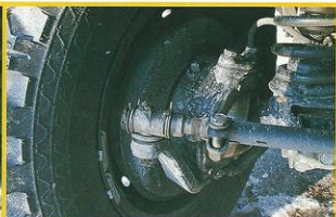
Nettes Detail: einer der nachstell- und reparierbaren Lenkschubstangenhebel. Dahinter die neu eingeführte Schraubenfeder
