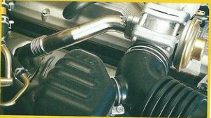
Die Abgasrückführung reicht aus, um den Motor ohne elektronische Einspritzregelung auf die aktuelle Abgasnorm zu bringen
