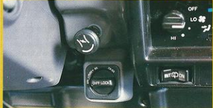
...das aber sind die Schalter, die echte Begeisterung auslösen können. Differenzialsperren gibt es vorn und hinten serienmäßig!
